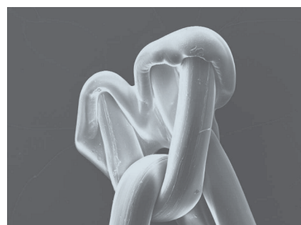
Cięcie laserowe w celu otrzymania zaokrąglonych, nieinwazyjnych brzegów włókien
